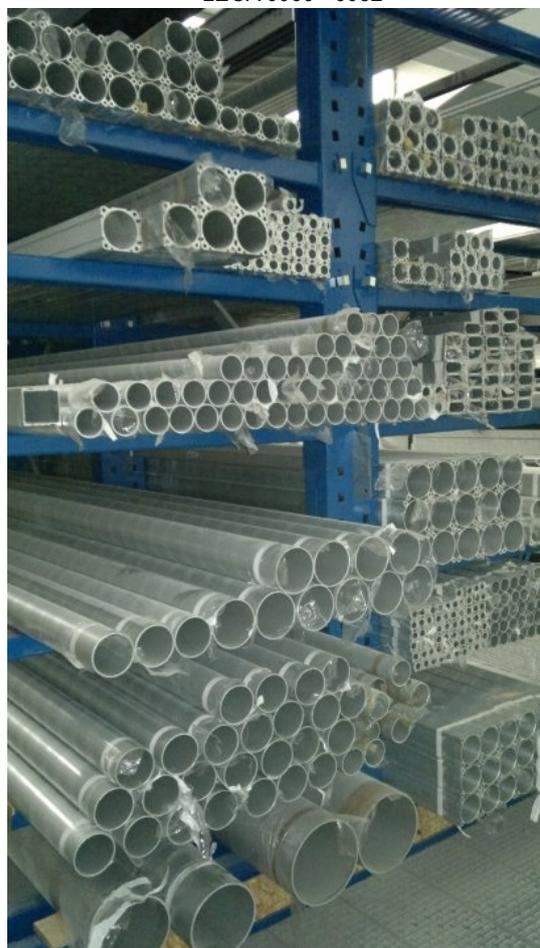
FOTO DI ESEMPIO: PROFILI IN ALLUMINIO ESTRUSO
